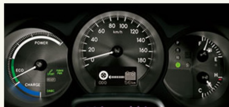
ハイブリッドシステムインジケータ（左） マルチインフォメーションディスプレイのエネルギーモニター表示 （スピードメーター内）
