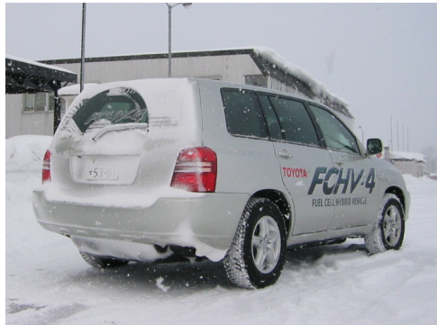
-30°Cでの始動と走行を実車で確認
