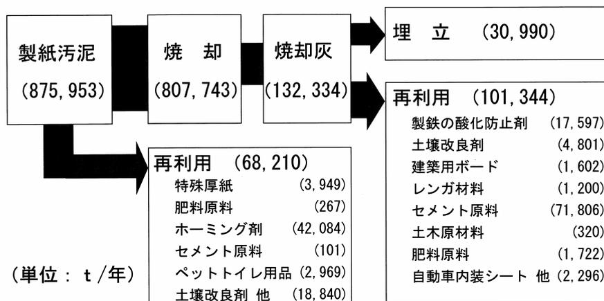
図 8 富士市における製紙汚泥の処理・処分状況 (平成 10 年度)
